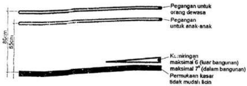
Gambar 5.11.1.d – Pegangan rambat pada ramp.
